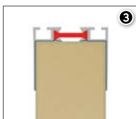
Profil haut en aluminium à rupture de pont thermique. Supprime le point de rosée.
